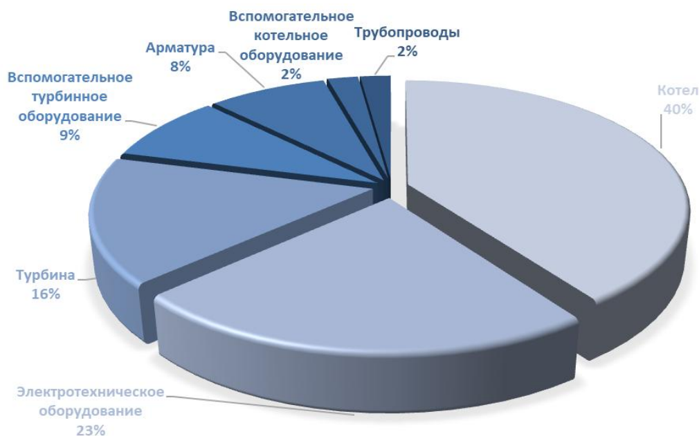
Рисунок. Распределение отказов по оборудованию ТЭС
